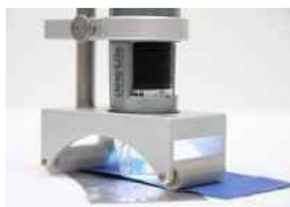
Le MS-W1 est un support particulier pour être utilisé pour se déplacer en avant ou en arrière sur des surfaces planes et cylindrique. Une solution idéale pour la vérification des objets plats tels que des tableaux.
