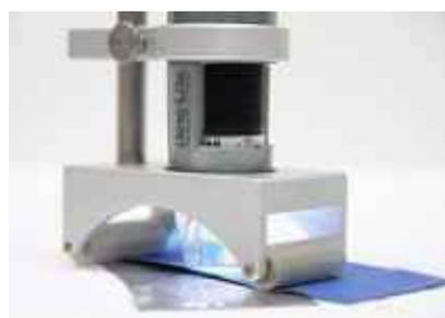
El MS-W1 es un soporte especial para ser utilizado para rodar hacia adelante o hacia atrás en superficies planas y cilíndricas. Una solución magnífica para comprobar objetos planos como cuadros.
