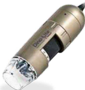
AM4113TL-FVW es la solución ideal para inspeccionar y trabajar con obras de arte que precisen del uso de luz UV. La amplia distancia de trabajo de hasta 15 cm permite al usuario trabajar debajo del microscopio. Este modelo ofrece un aumento de hasta 90x y luces LED conmutables entre luz UV y luz blanca. La luz UV ofrece una onda de 400nm. Está equipado con un filtro que bloquea la luz UV de vuelta, produciendo imágenes con colores naturales.
