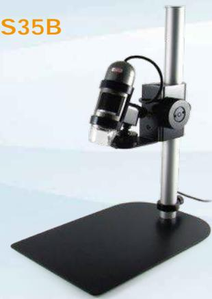
Das MS35B ist ein stabiles Tischstativ für das Dino-Lite digitale Mikroskop. Es bietet eine 360° horizontalen Orientierung sowie einen vertikalen Arbeitsabstand von 20 cm.
